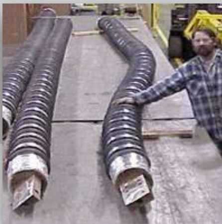
Cables de arco eléctrico
